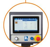
La pantalla de control AutoTouch™ permite acceder a tutoriales para el operador, sistema de ayuda, diagnóstico integrado y monitoreo del funcionamiento del equipo
